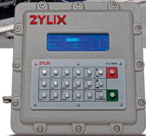
de carregamento, sendo que cada braço tem suas próprias parametrizações, tais como tipo de carregamento, alarmes, receitas, etc. É como se fossem quatro computadores de vazão dentro de apenas um equipamento.
